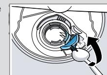
4. Kryt čerpadla vypáčte pomocou lyžice a uchopte ho za prepážku.
